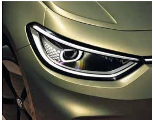
Die Matrix-Technologie ermöglicht eine dauerhafte Fernlichtfahrt.
