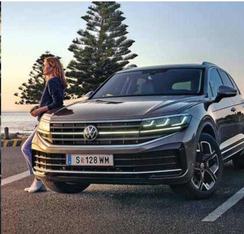
Erstmals beleuchtet: die mittlere Querspange im Kühlergrill
